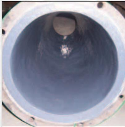
Los **revestimientos de caucho** típicamente son perjudicados por fallas del pegamento en las costuras, lo que puede ocasionar una deslaminación catastrófica de las planchas.
